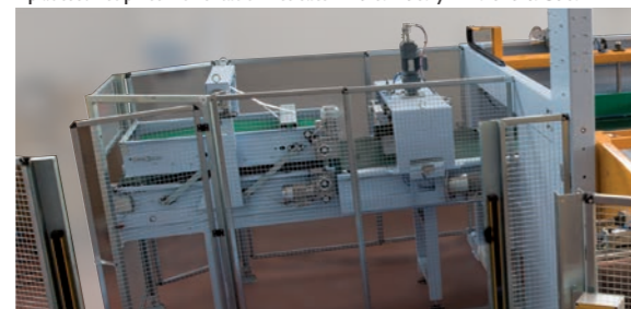
Gruppo Pressasacchi a nastro in entrata al palettizzatore; con regolazione dell'altezza di pressatura manuale, oppure, a richiesta motorizzata. Pinza orientasacco con rotazione, in entrambi i sensi, comandata da encoder.
