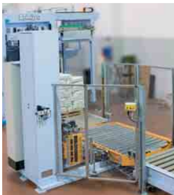
Due immagini dell'avvolgitore MYtoo-Pr, a piattaforma rotante, entrambe in uscita dal palettizzatore RUNNER-a; per produzioni fino a 35 pallet/h. Two pictures of turntable-rotating platform MYtoo-Pr wrapper, both at RUNNER-a palletizer outlet; for outputs up to 35 pallets/h. Deux présentations de la banderoleuse Mytoo-Pr à plateau tournant, positionnée en sortie du palettiseur RUNNER-a pour une cadence jusqu'à 35 palettes/h. Dos imágenes del envolvedor MYtoo-Pr, a plataforma rotante, ambas a la salida del palettizador RUNNER-a; para producciones hasta 35 pallet/h.
