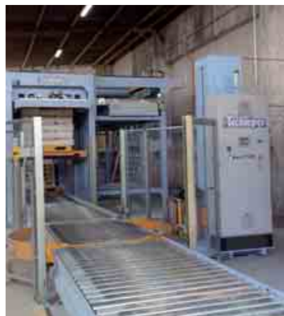
Due immagini dell'avvolgitore MYtoo-Pr, a piattaforma rotante, entrambe in uscita dal palettizzatore RUNNER-a; per produzioni fino a 35 pallet/h. Two pictures of turntable-rotating platform MYtoo-Pr wrapper, both at RUNNER-a palletizer outlet; for outputs up to 35 pallets/h. Deux présentations de la banderoleuse Mytoo-Pr à plateau tournant, positionnée en sortie du palettiseur RUNNER-a pour une cadence jusqu'à 35 palettes/h. Dos imágenes del envolvedor MYtoo-Pr, a plataforma rotante, ambas a la salida del palettizador RUNNER-a; para producciones hasta 35 pallet/h.
