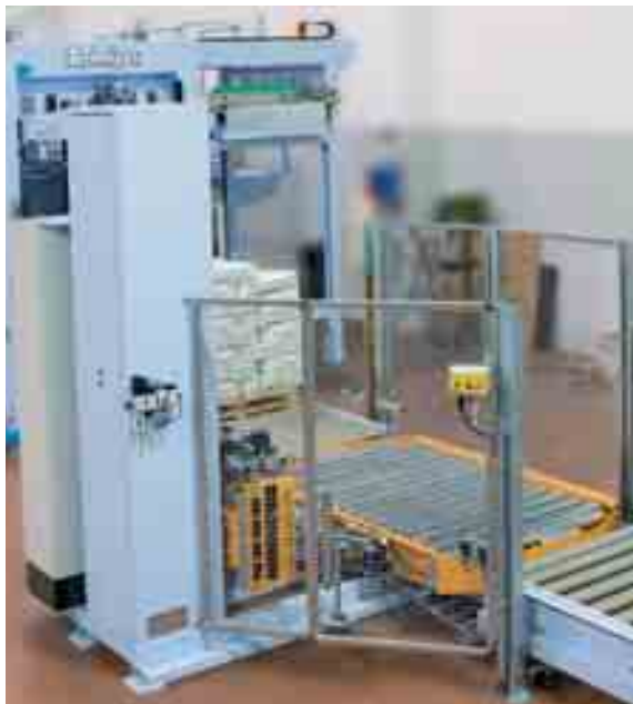
Due immagini dell'avvolgitore MYtoo-Pr, a piattaforma rotante, entrambe in uscita dal palettizzatore RUNNER-a; per produzioni fino a 35 pallet/h. Two pictures of turntable-rotating platform MYtoo-Pr wrapper, both at RUNNER-a palletizer outlet; for outputs up to 35 pallets/h. Deux présentations de la banderoleuse Mytoo-Pr à plateau tournant, positionnée en sortie du palettiseur RUNNER-a pour une cadence jusqu'à 35 palettes/h. Dos imágenes del envolvedor MYtoo-Pr, a plataforma rotante, ambas a la salida del paletizador RUNNER-a; para producciones hasta 35 pallet/h.
