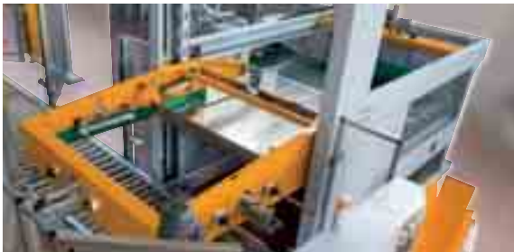
Gruppo formazione dello strato costituito da: area di preformazione e spintore trasversale a paletta sulla piattaforma mobile verticale per il deposito dello strato formato sulla paletta ferma sulla zona di carico.
