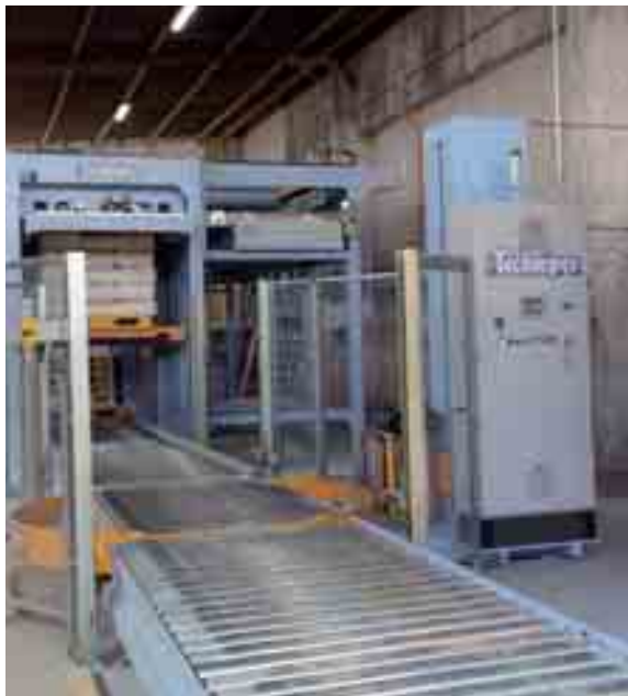
Due immagini dell'avvolgitore MYtoo-Pr, a piattaforma rotante, entrambe in uscita dal palettizzatore RUNNER-a; per produzioni fino a 35 pallet/h. Two pictures of turntable-rotating platform MYtoo-Pr wrapper, both at RUNNER-a palletizer outlet; for outputs up to 35 pallets/h. Deux présentations de la banderoleuse Mytoo-Pr à plateau tournant, positionnée en sortie du palettiseur RUNNER-a pour une cadence jusqu'à 35 palettes/h. Dos imágenes del envolvedor MYtoo-Pr, a plataforma rotante, ambas a la salida del paletizador RUNNER-a; para producciones hasta 35 pallet/h.
