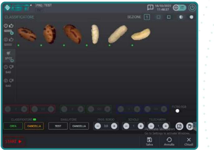
Logiciel **développé en interne**, ayant pour objectif de permettre à l'opérateur de gérer totalement les programmes en toute autonomie. Grâce à un système d'**Auto-apprentissage**, il est possible de créer un programme en quelques minutes à travers la collecte automatique des images des produits conformes et de tous les défauts à éliminer.
